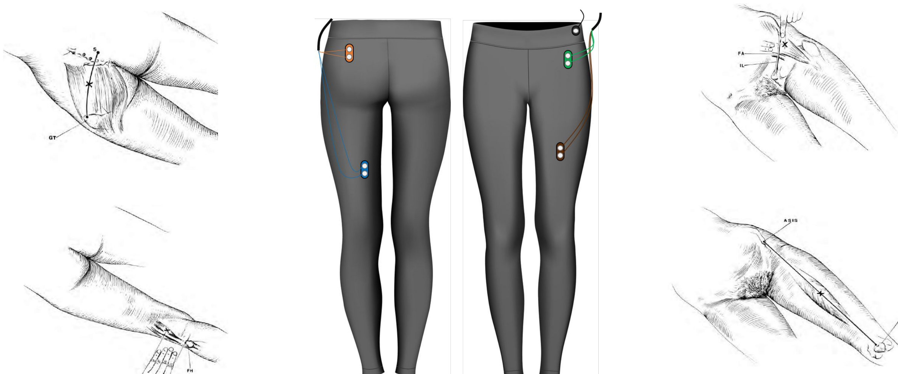
Fig. 4 Leggings con electrodos y los principales músculos donde los electrodos serán posicionados para la adquisición de señal.
